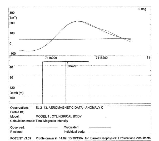
EXPECTATION PTY LTD EL 2143, AEROMAGNETIC SURVEY – ANOMALY C MODEL 1 : CYLINDRICAL BODY
